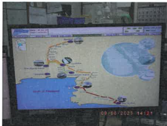
รูปที่ 2-26 หน้าจอระบบ Leak Detection
